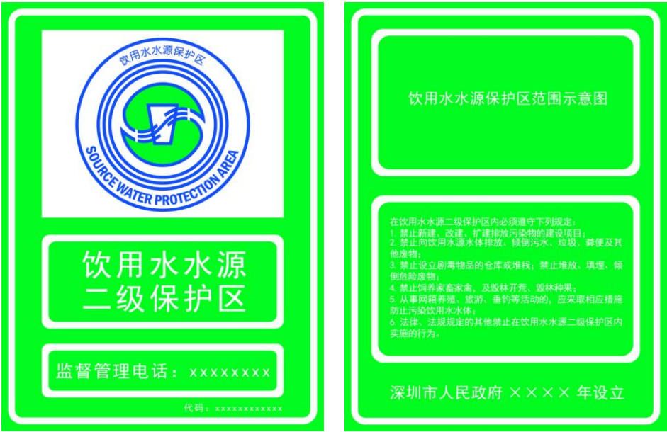
图3 饮用水水源二级保护区界标正面、背面示意图
