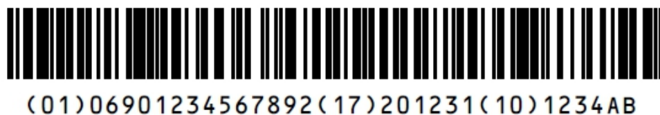
图2 包含 UDI-DI 和 UDI-PI（有效日期和批号）串联的 GS1-128 码
