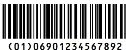
图3 包含 UDI-DI（上）和 UDI-PI（有效日期和批号）（下）并联的 GS1-128 码
