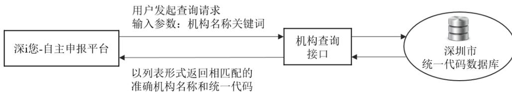
图B.1 以机构名称为查询参数的模糊查询接口流程
