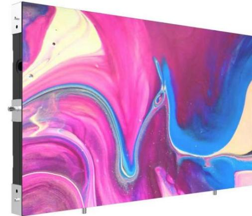
适用于Mini LED芯片尺寸小于200um，像素间距范围为0.3 ~ 1.5mm，工作在0°C ~ 40°C、湿度85%以下的室内环境中的，采用Mini LED直显方案的超高清显示屏。
