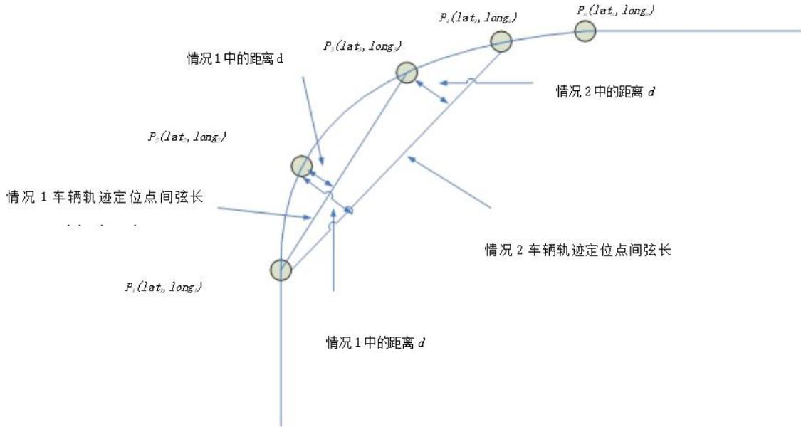
图 E. 5 方法三的 PH Error 计算方法示意图
