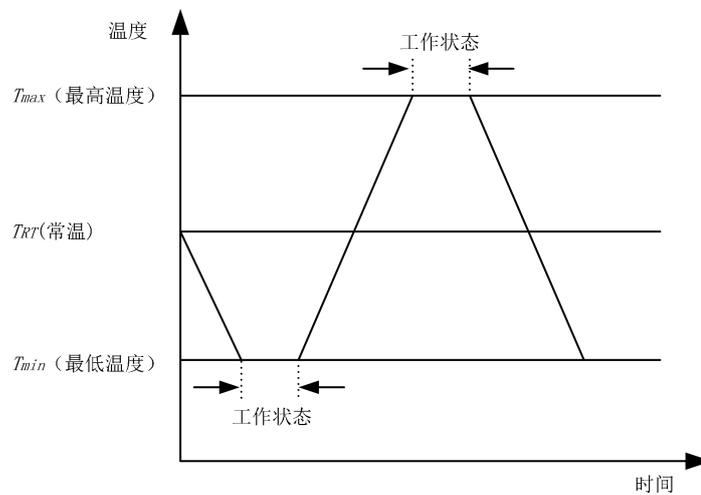
图 H.1 耐久寿命试验温度曲线
