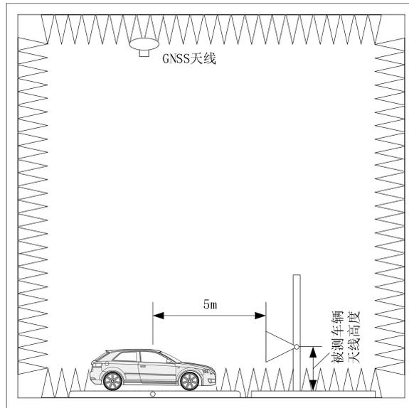
图 7 功能试验测试系统侧视图
