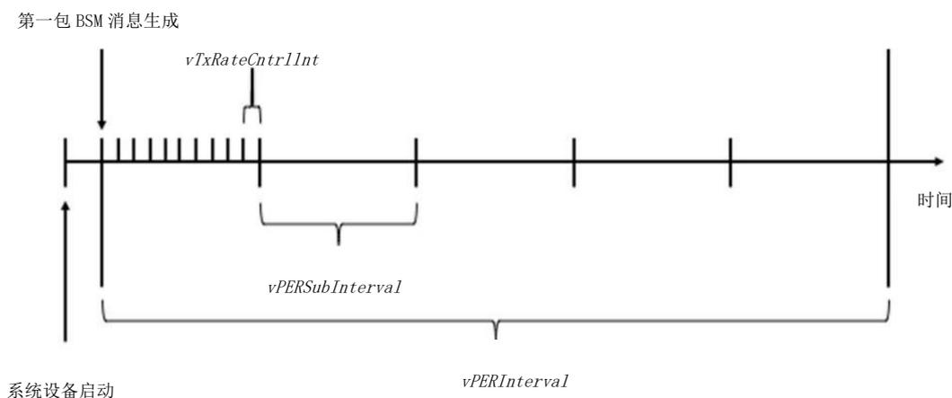
图 C.1 参数  $vPERSubInterval$ 、 $vPERInterval$  和  $vTxRateCntrlInt$  之间的关系
