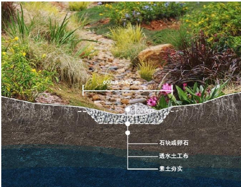
图 A.12 旱溪典型构造示意图
