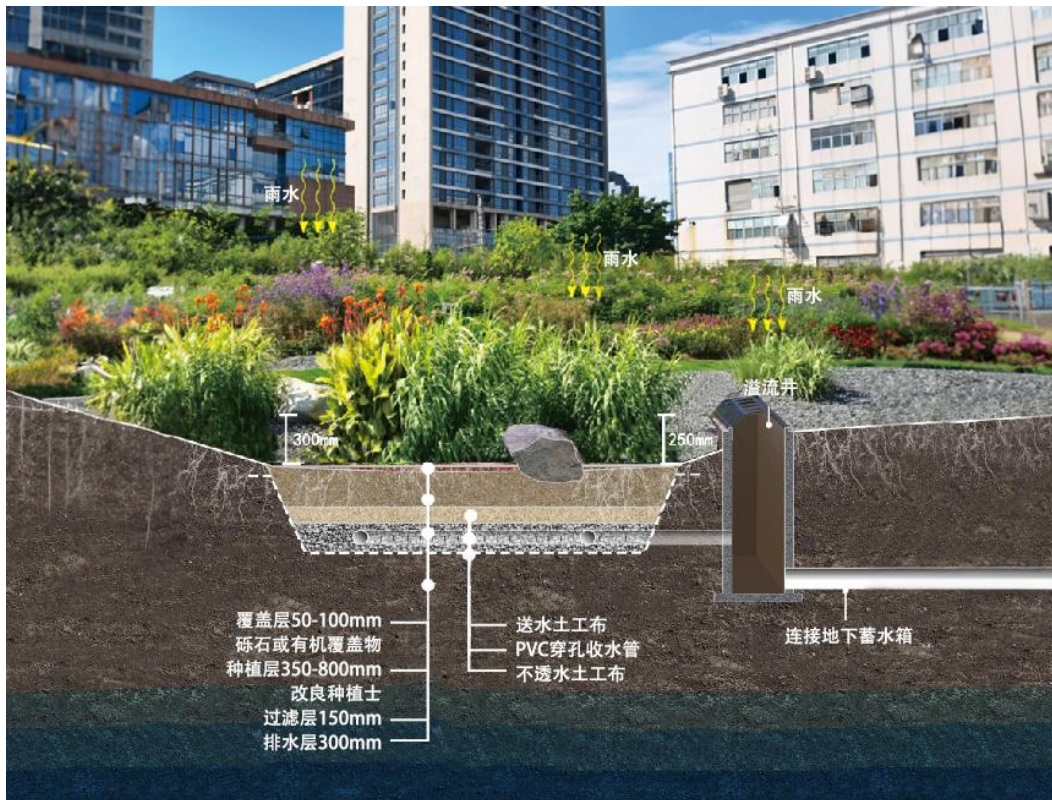
图 A.4 生物滞留设施典型构造示意图
