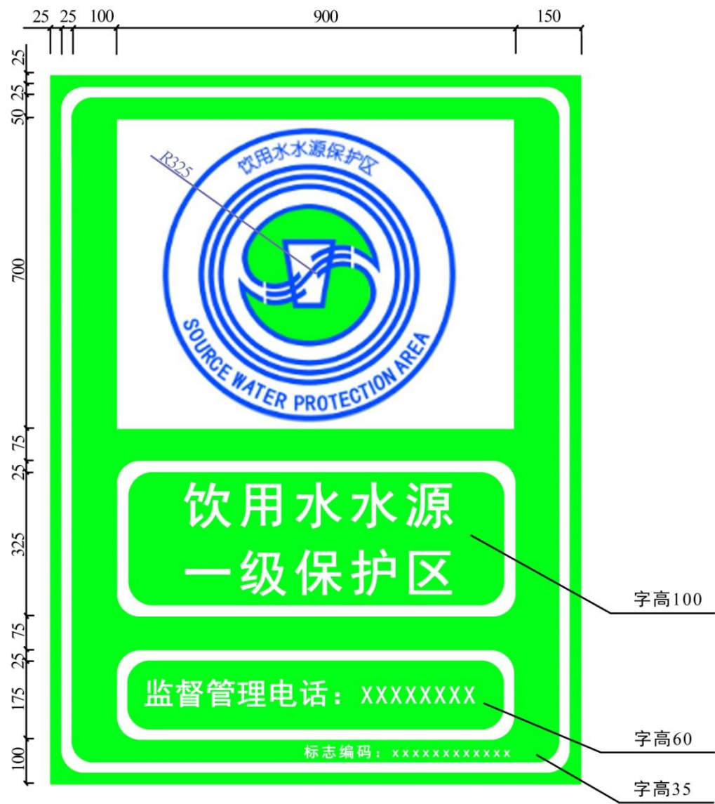
图 B.1 饮用水水源一级保护区界标正面图示及尺寸（单位：mm）
