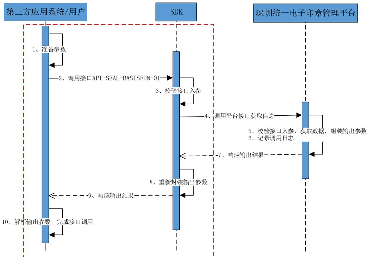
图 1 获取可用印章列表流程
