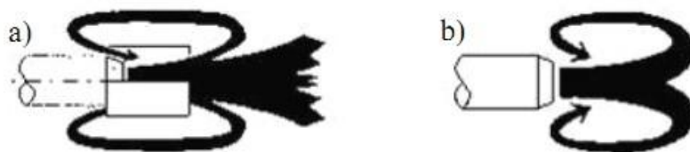
图 4-6 烟气内循环：a) 再循环罩，b) 射流卷吸
